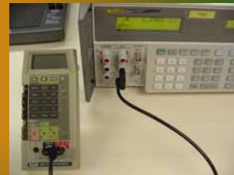
Calibración de un multímetro fluke 8060 a
